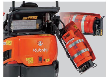
Selon les conditions de travail, une bouteille de GPL permet à votre mini-pelle de travailler une journée complète. Contrairement au carburant diesel, le GPL ne peut pas se déverser et contaminer le milieu environnant. Un capot rigide protège la bouteille contre l'agression de la lumière directe et autres corps étrangers.
